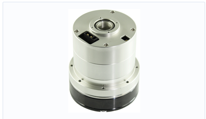
图 9-1 输出端（左， \Phi 44 分布圆 / 8 \times M3 / \Phi 13 中心孔）与电气端（右，板载接口）
